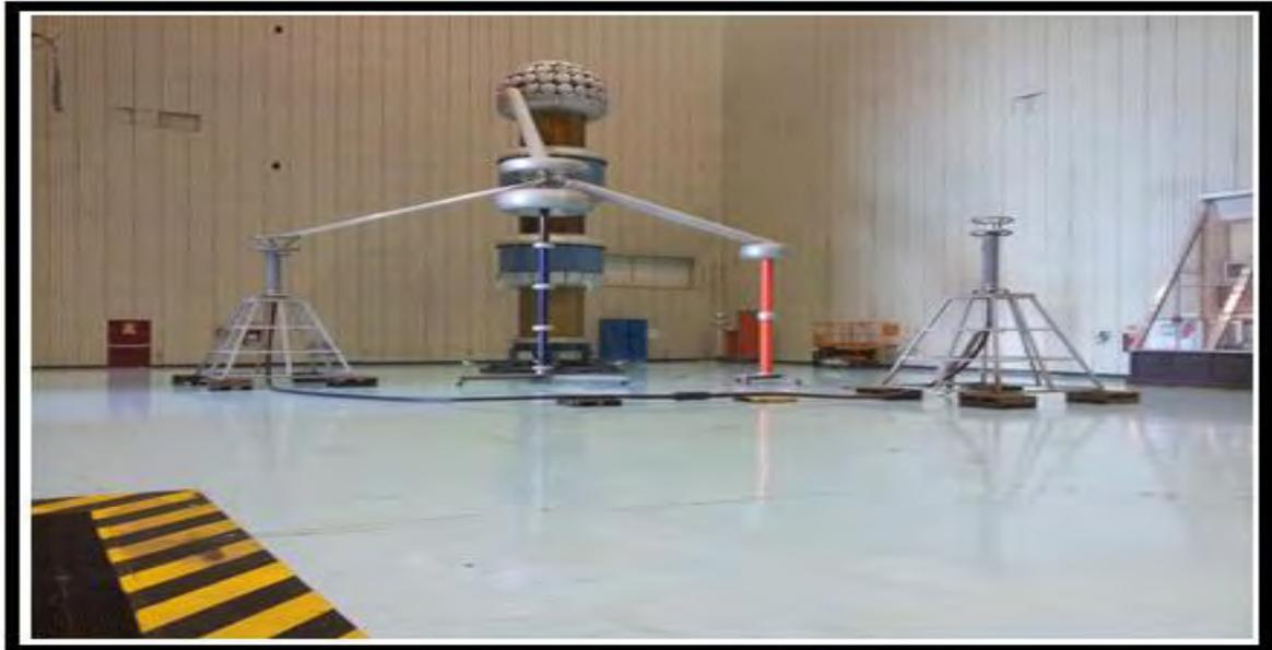
**Figura 4.26 Montaje de medición de cable de 115 V, método directo.**
