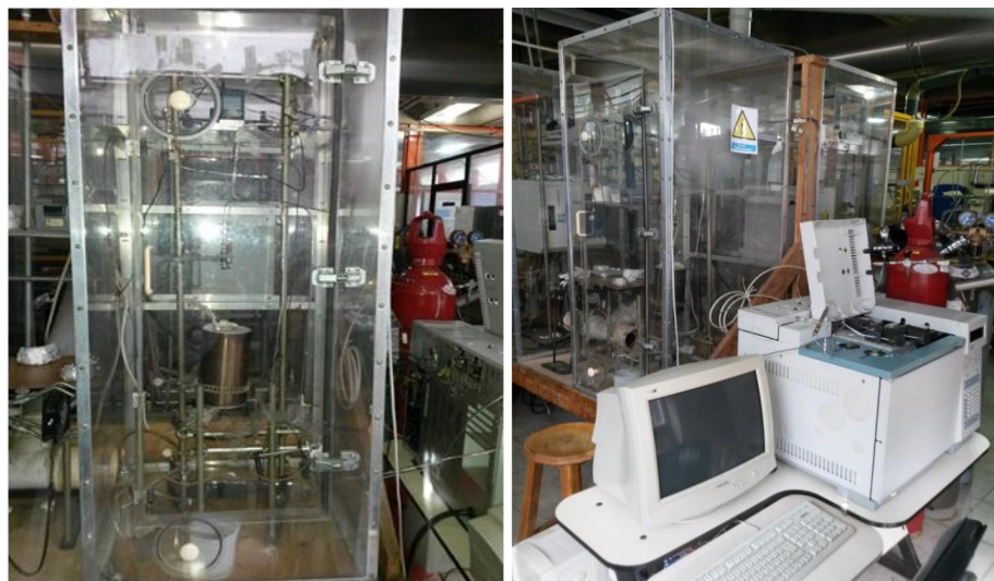
Figura 12. Sistema de reacción para el RSM y Cromatógrafo de Gases Hewlett Packard, HP 6890 series GC System , ubicados en el Laboratorio de Cinética y Catálisis, ULA.
