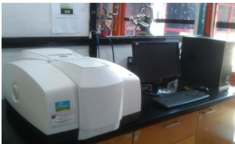
Figura 8. Espectrofotómetro FT-IR, Marca Perkin Elmer, Modelo Frontier, Laboratorio de Cinética y Catálisis de la ULA.
