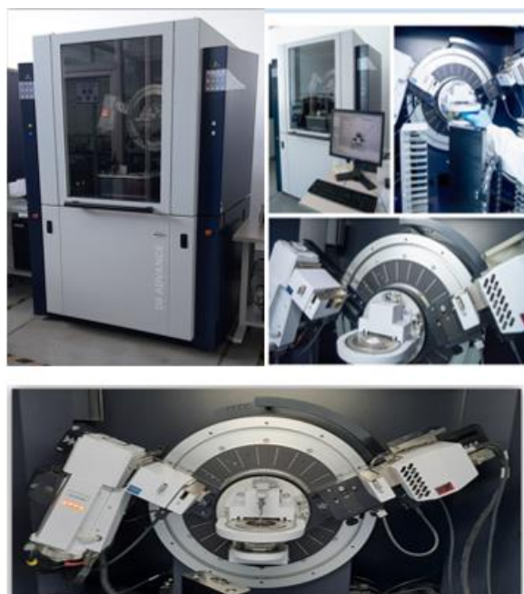
Figura 10. Difractómetro Bruker D8 Advance, Perteneciente al Laboratorio de rayos X, universidad industrial de Santander.
