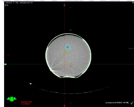
Figura 60: Tomografía de planificación del maniquí con la delimitación para el detector tipo MOSFET número cuatro, así como la esfera sobre la que se calcularán las dosis.
