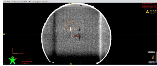
Figura 83: CBCT del maniquí en el posicionamiento del maniquí con la visión del detector tipo MOSFET 4
