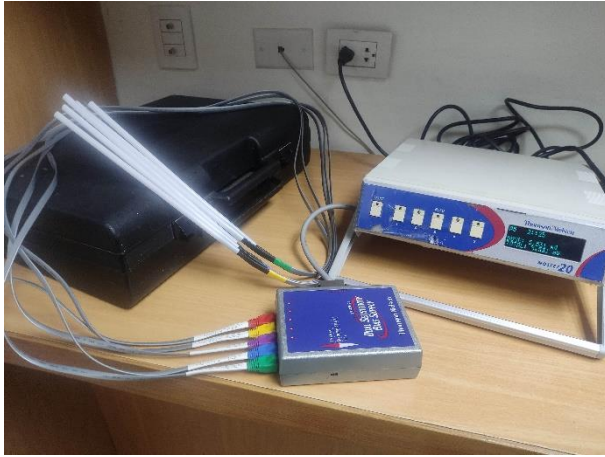
Figura 48: Sistema de verificación de dosis en pacientes: MOSFET20, TN-RN-50 de Thomson & Nielsen
