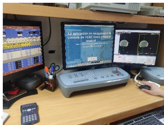
Figura 67: Consola de control del Acelerador lineal y sistema de imágenes para la verificación de posicionamiento
