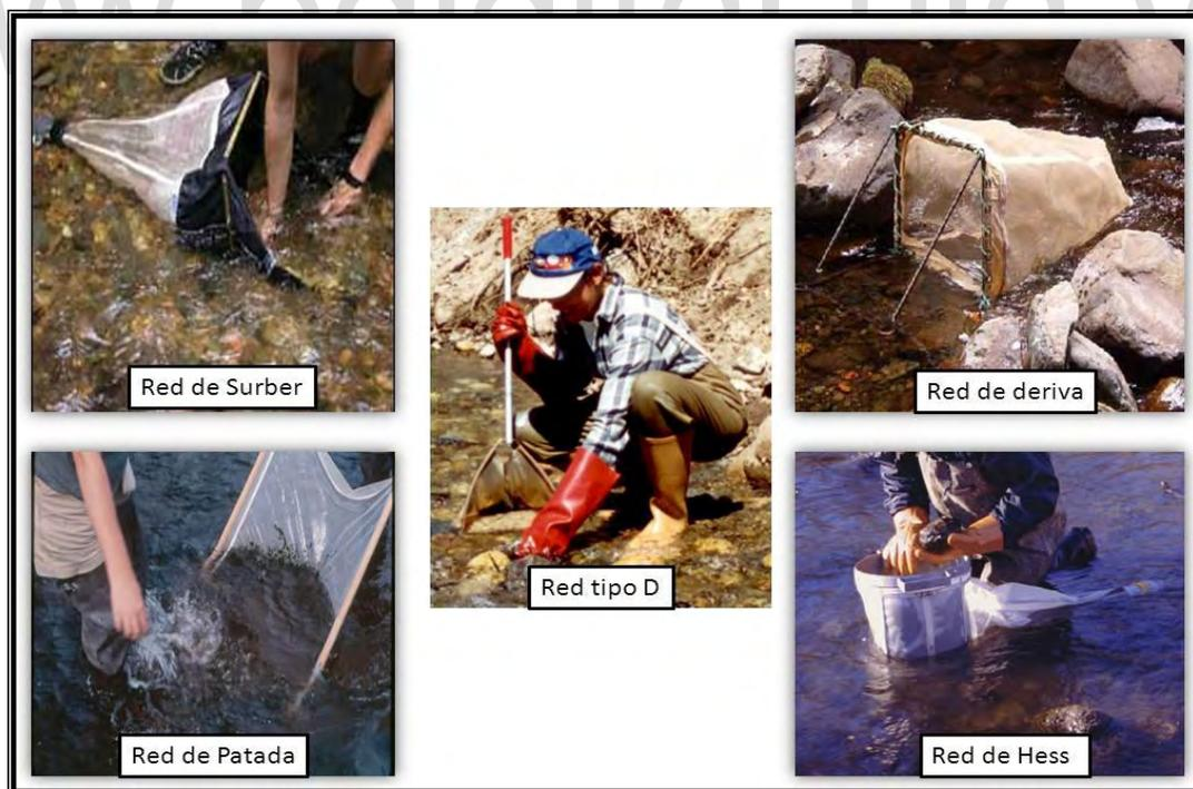
**Figura 3. Redes manuales comúnmente usadas para la recolección de macroinvertebrados acuáticos.**
