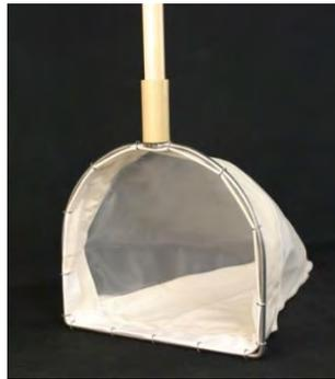
**Figura 5. Red de mano tipo D, utilizada para la recolección de macroinvertebrados acuáticos (Tomado de <http://envco.co.nz/catalog/product/invertebrate-nets/turtox%C2%AE-d-frame-dip-nets.html>).**
