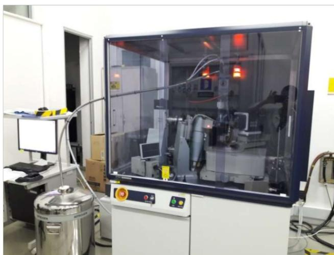
*Figura 19. Difractómetro Rigaku XtaLABPro del Laboratorio de Rayos X de la Universidad Industrial de Santander, Bucaramanga, Colombia.*
