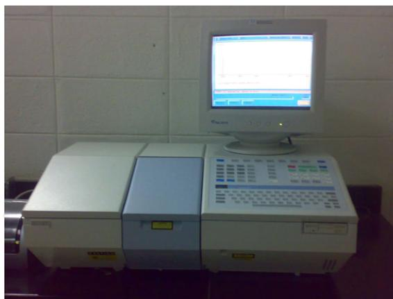
*Figura 7. Espectrofotómetro Infrarrojo marca Perkin Elmer modelo RX1 perteneciente al Laboratorio de Docencia de Química Orgánica de la Facultad de Ciencias.*
