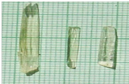
*Figura 4. Cristal de cloruro de tiosemicarbazida de cadmio monohidratado, obtenido por evaporación lenta de solvente.*
