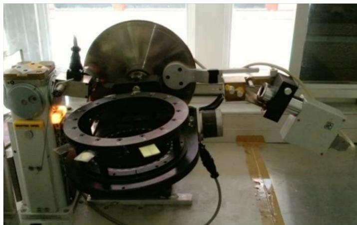
*Figura 16. Difractómetro de Rayos X de muestras policristalinas Philips PW 1050/25 automatizado por Crystal Logic, Inc. del Laboratorio de Cristalografía.*
