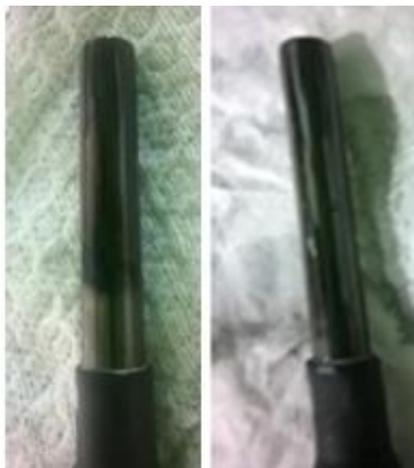
**Figura 49- Fotografías electrodo de trabajo después de la electrólisis a -1600 mV, llevada a cabo durante 60 minutos en atmósfera inerte.**
