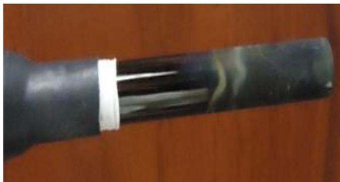
Figura 29- Fotografía del electrodo de trabajo luego de llevar a cabo la metalización de la porfirina vía electroquímica.
