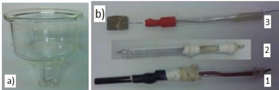
**Figura 19- a) Celda electroquímica para metalización vía química 19b) Sistema de tres electrodos: 19b-1) Electrodo de trabajo, 19b-2) Electrodo de referencia 19b-3) Contraelectrodo.**
