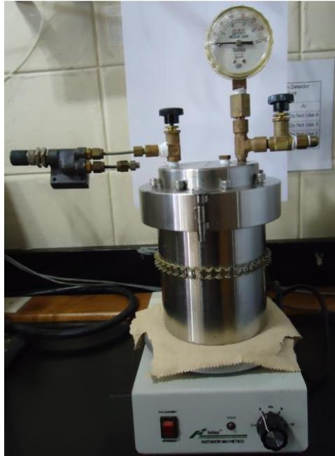
Figura 21- Reactor de alta presión.
