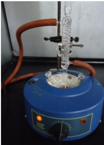
**Figura 32- Sistema de reflujo para metalización vía química de la meso-tetra-(p-sulfonatofenil) porfirina de sodio, empleando acetato de cobalto tetrahidratado.**
