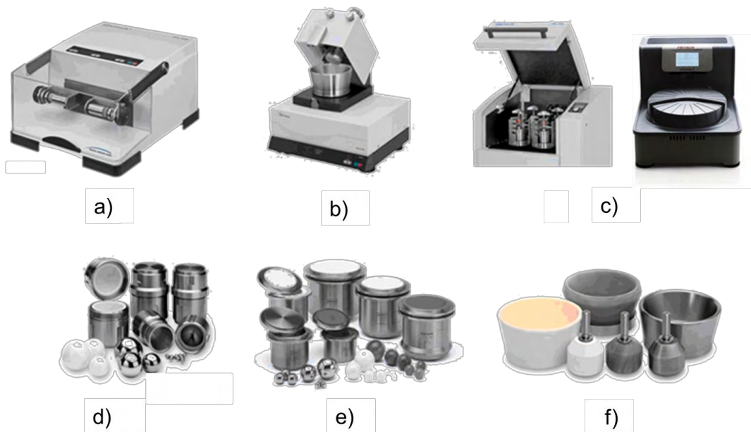
Figura 23: Reactores para mecano-síntesis: a) Molino de esferas; b) Molino de mortero; c) Izquierda: Molino planetario de esferas Derecha: Molino planetario para triturar hasta el rango de nanómetros ; d) y e) Esferas y contenedores; f) Morteros y manos.
