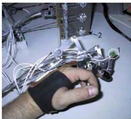
Figura 1. 6: Exoesqueleto para la rehabilitación de los dedos de la mano capaz de intervenir cuatro GdL (Wege y Hommel, 2005)
