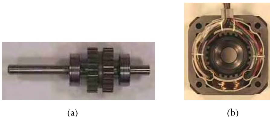
Figura 2. 10: (a) Rotor de un motor de imán permanente (b) Estator de un motor de imán permanente
