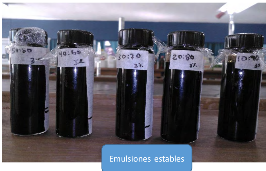
Figura 6.10. Estabilidad de las emulsiones W/O a 3% de asfaltenos luego de 24 horas de emulsificación
