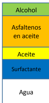
Figura 5.4 Composición de la emulsión adicionando el surfactante en la fase oleosa.
