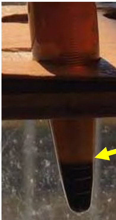
Figura6.42A. Volumen de precipitado empleado el dispersante D-452
