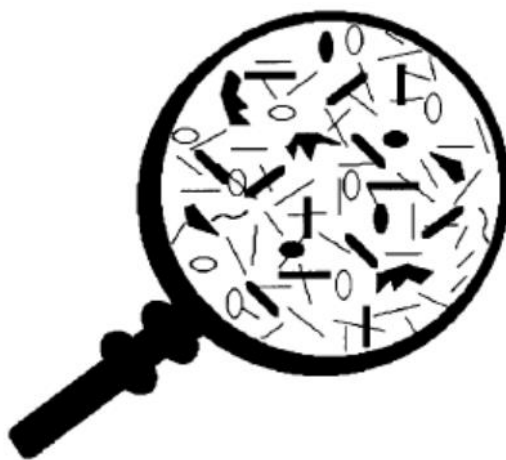
Figura 2.11. Composición del petróleo a nivel microscópico. Las líneas rectas y curvas representan las moléculas parafina, las elipses solidas representan los aromáticos y las elipses huecas las resinas y las formas solidas representan las moléculas asfaltenos.
