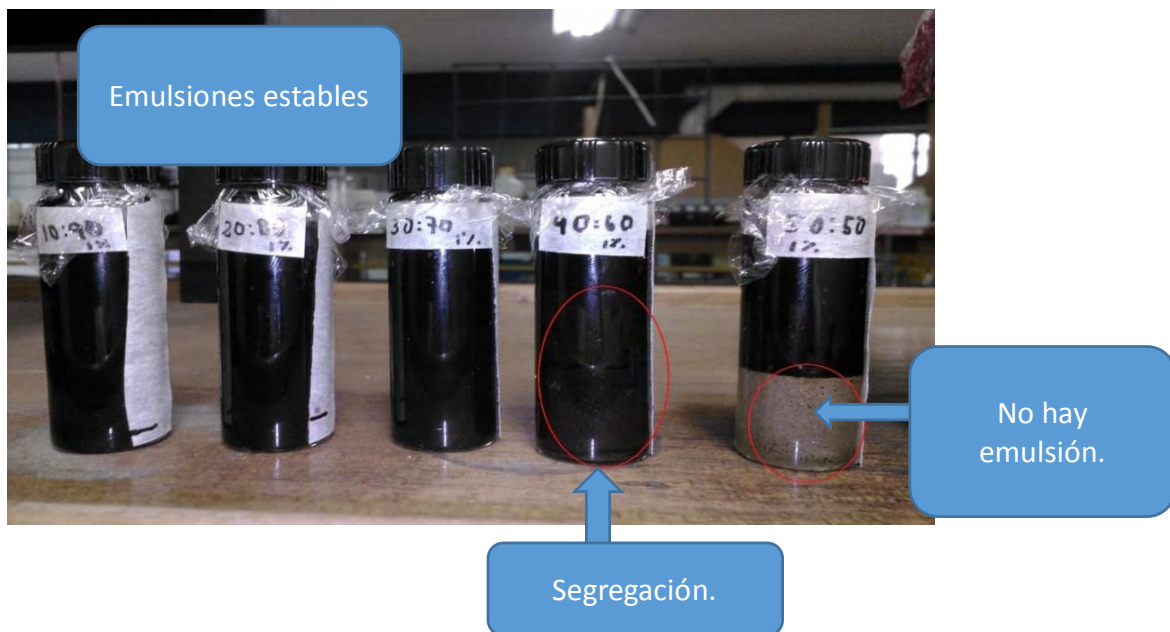
Figura 6.7. Apariencia de las emulsiones O/W a 1% de asfaltenos luego de 24 horas de emulsificación.
