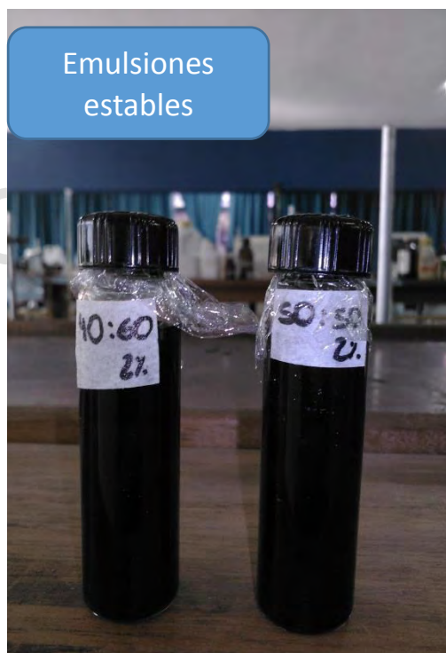
Figura 6.9. Estabilidad de las emulsiones W/O a 2% de asfaltenos luego de 24 horas de emulsificación.
