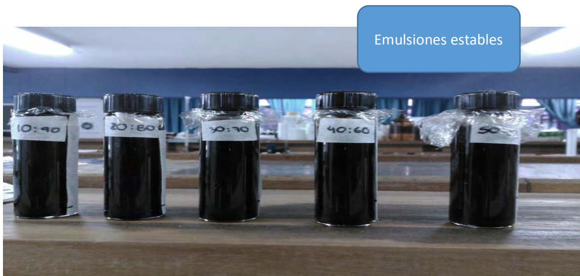
Figura 6.8. Apariencia de las emulsiones W/O a 5% de asfaltenos luego de 24 horas de emulsificación.
