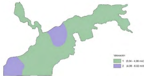
Fig. 4.46. Reclasificación de la conductividad hidráulica. (Parámetro Cr).
