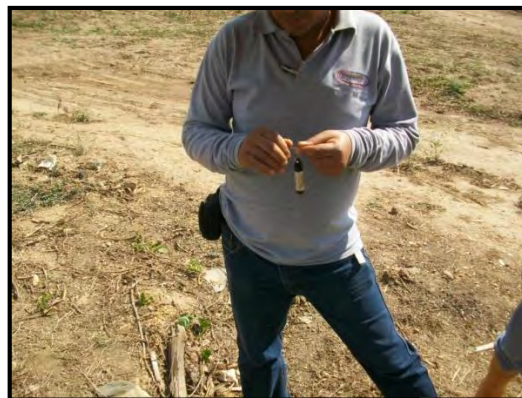
Fig. 4.12. Ajuste del Diver para ingresarlo en el pozo.
