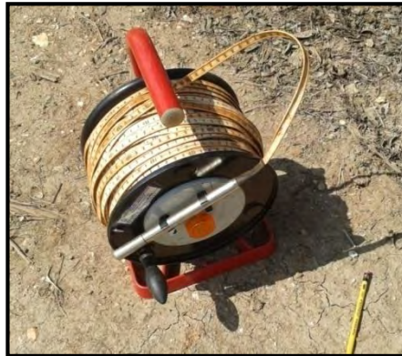
Fig. 4.6. Sonda automática de medición
