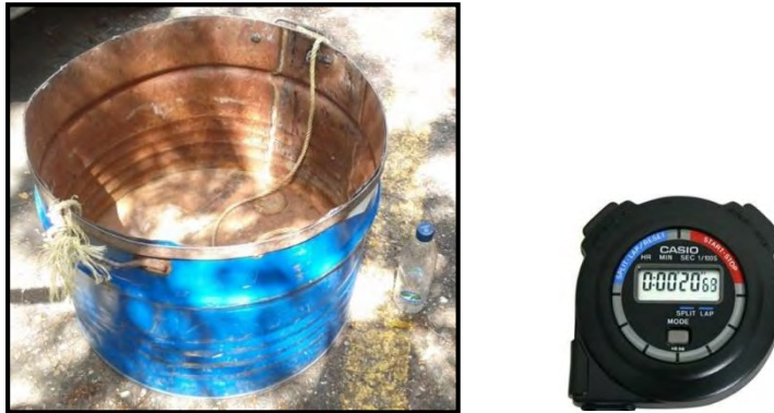
Fig. 4.4. Equipo utilizado para realizar el método volumétrico
