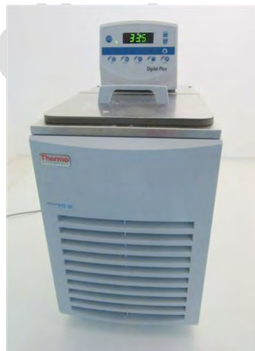
Figura 17. Thermo scientific Neslab RTE 10.
