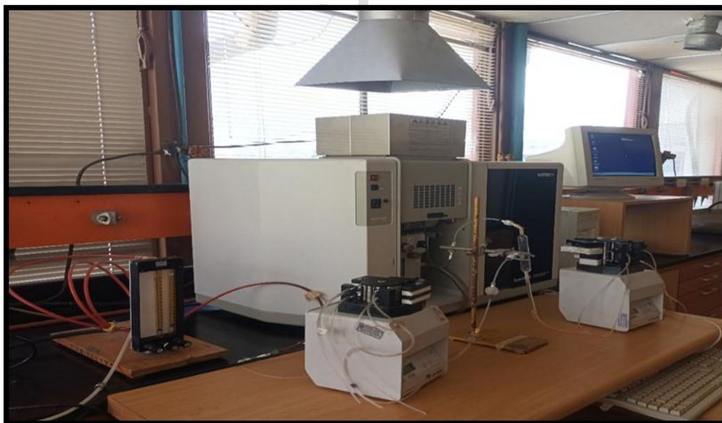
Anexo 3. Espectrofotómetro de absorción atómica VARIAN SpectrAA 110 y sistema de generación de hidruros en flujo continuo.
