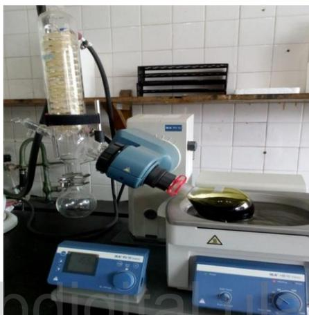
**Figura 15.** Concentración del extracto en rotavaporador IKA RV10.
