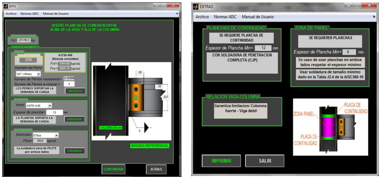
Figura 11. Ventana gráfica para la conexión BFP: a) Diseño alma viga- ala columna y b) Diseño planchas de continuidad, planchas en zona de panel y relación columna fuerte- Viga débil. Fuente: Los Autores
