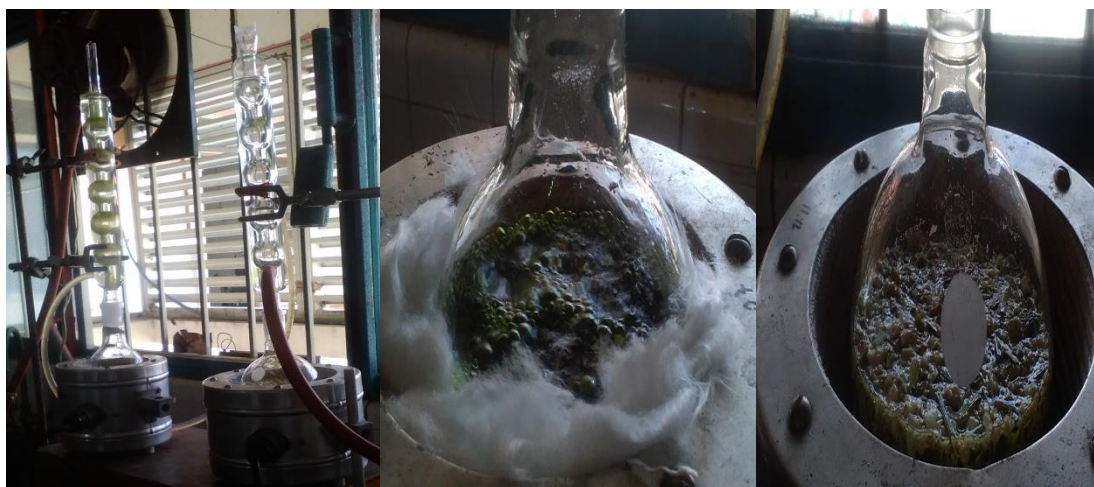
Figura 20. Extracción continua en caliente bajo reflujo.
