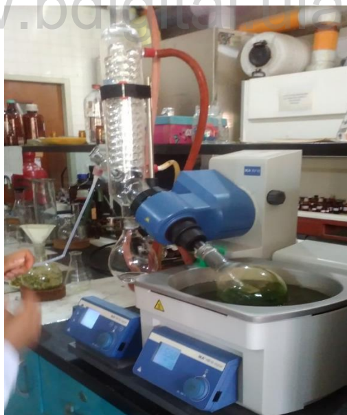
Figura 22. Concentración de los extractos en el rotavapor.
