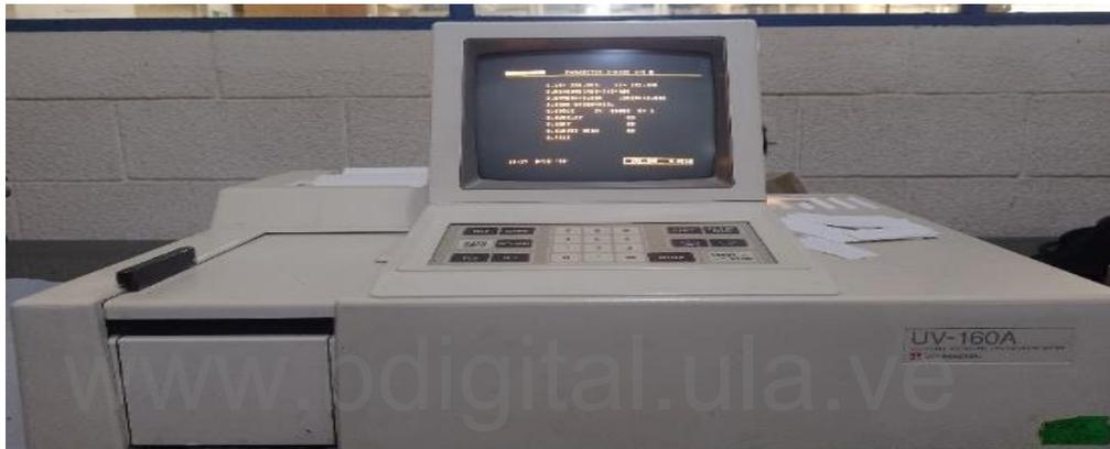
**Figura 10.** Espectrofotómetro UV-160A Marca Shimadzu. **Fuente:** Gomez, H., Salazar, C., Rojas, J. (2023).
