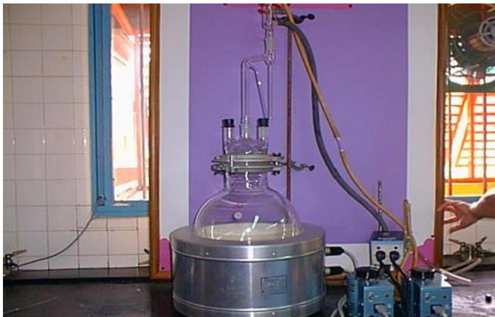
Figura. 12. Técnica de extracción: Destilación por arrastre con vapor de agua. Tomado del Laboratorio “B” del Instituto de Investigación de la Facultad de Farmacia y Bioanálisis de la Universidad de Los Andes.
