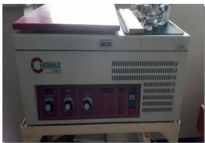
Centrífuga HERMLE Z 360 K (Capacidad para 24 tubos eppendorf y 8 Falcon).
