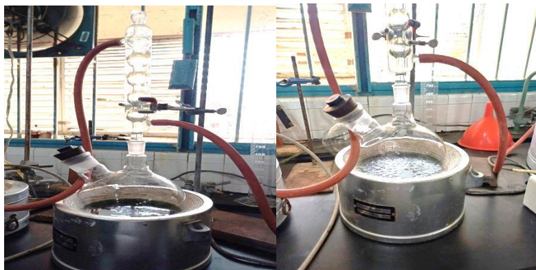
Figura 12. Extracción continua en caliente bajo reflujo
