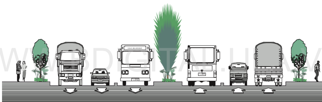
Figura 2.7: Características de la red vial de un sistema de transporte masivo Trolebús ( Wright et al., 2010 )
