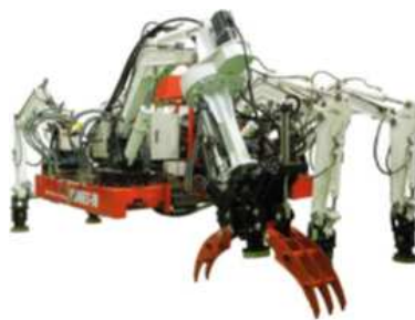
Figura 1.11: COMET-IV Modo de Trabajo, Herramienta de pala Excavadora en la extremidad frontal derecha. Fuente: Nonami et al. (2014, p.12).
