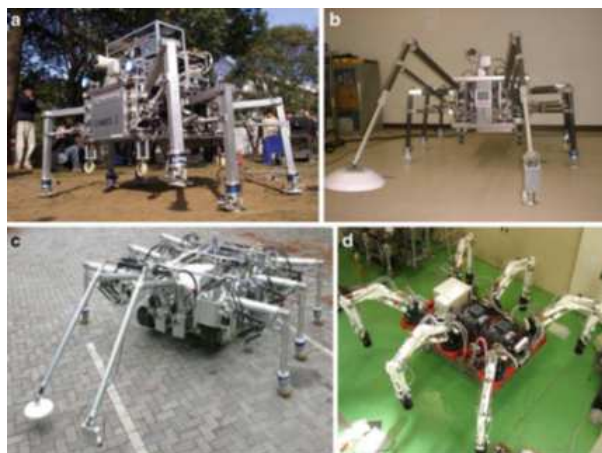
Figura 1.10: Hexápodo COMET Universidad de Chiba, Japón. (a) COMET-I, (b) COMET-II, (c) COMET-III, (d) COMET-IV. Tomado de: Hydraulically Actuated Hexapod Robots , Nonami et al. (2014, p.12).
