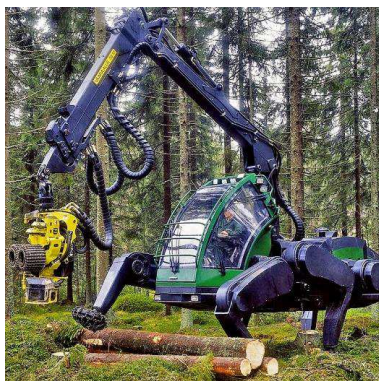
Figura 1.9: Tractor Walking Harvester de John Deere en el año 2002 con sierra de grúa de TimberJack. (Forest Industries Network, 2005)
