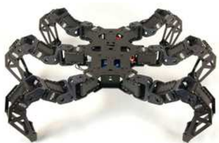
Figura 1.20: Hexápodo PhantomX AX MARK II distribuido por TrossenRobotics Inc. Tomado de: (TrossenRobotics, 2015)
