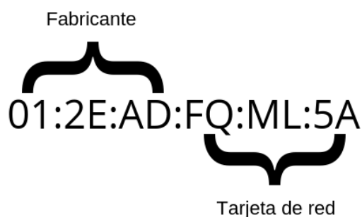
Figura 2.3: Dirección física o MAC de un dispositivo.
