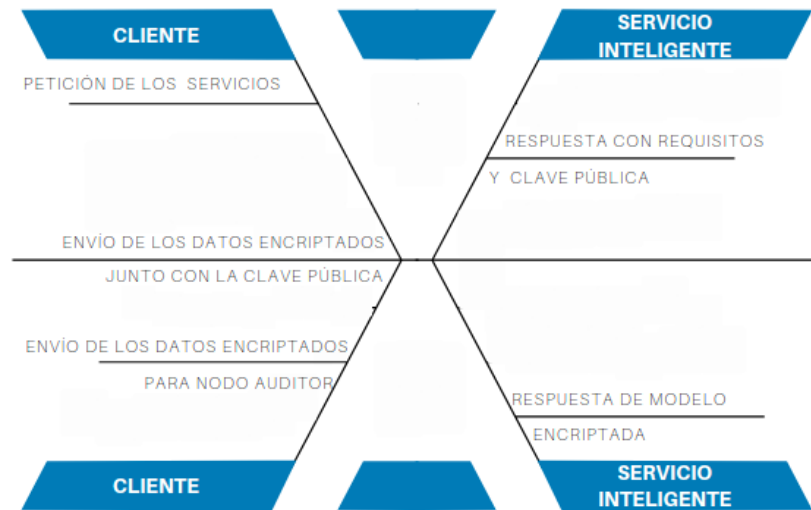
Figura 3.6: Protocolos de comunicación de la red con la presencia de auditor.
