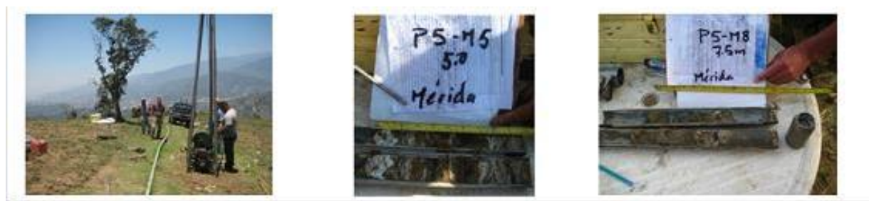
Figura 27. Ejemplo de la realización de la perforación; a partir del método SPT, Nro. 5 en la unidad de vertiente, sector Loma de San Francisco, municipio Libertador.
