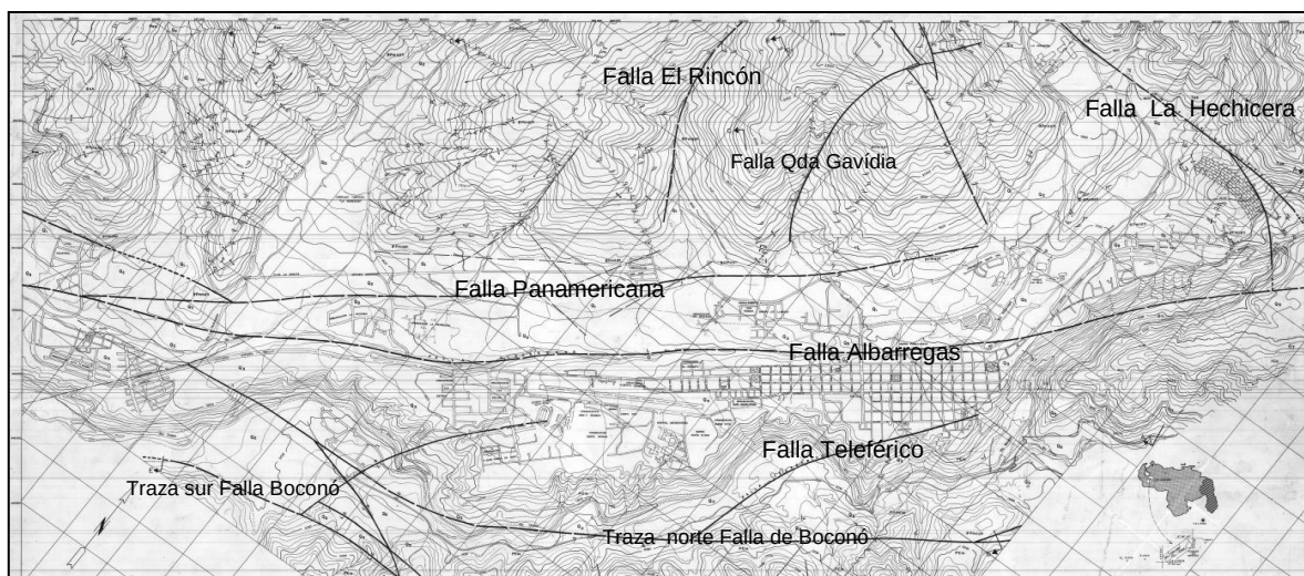
Figura 61. Mapa geológico estructural, donde se muestran las principales fallas y lineaciones estructurales de la ciudad de Mérida (Tomado de: Oliveros 1977).
