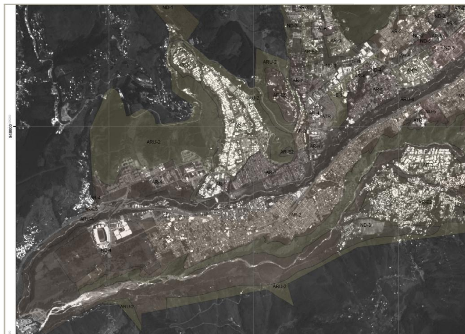
Figura 49. Ilustración del procedimiento de superposición de los usos urbanos sobre la imagen Spot5 pancromática, para realización del posterior análisis de conflictos de uso de acuerdo al uso actual.
