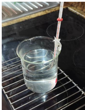
Figura 31. Tope eléctrico, rejilla metálica, vaso precipitado y termómetro Fuente propia.
