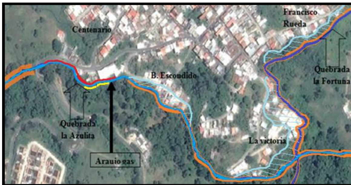
Figura 8. Amenaza Hidrogeológica casco urbano de la Azulita. Zona propensa a deslizamiento rotacional (resaltado en color amarillo), zona propensa a deslizamiento traslacional (resaltado de color anaranjado), zonas inundables (azul celeste con rayas).
