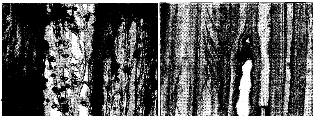
Figura 20. Corte longitudinal de la madera de Pino sin tratamiento, después de 12 semanas de incubación en suelos no estériles. A) Se observa la presencia de hifas abundantes colonizando el interior de la madera. B) Degradación total del parénquima radial.
