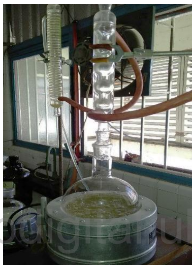
Figura 9. Proceso de extracción por Reflujo de los tallos de Swinglea glutinosa
