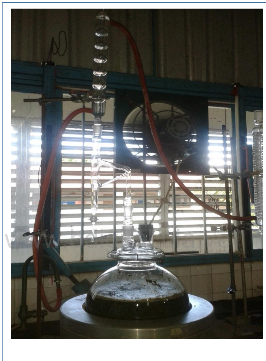
Anexo 8. Proceso de extracción del aceite en la especie B. nitida (hidrodestilación)
