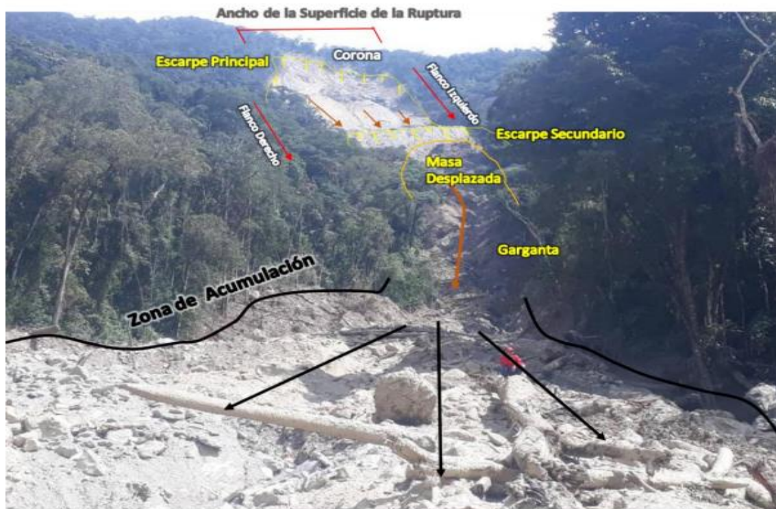
Figura 23. Caracterización del movimiento de masa en la microcuenca Escorial, in situ.
