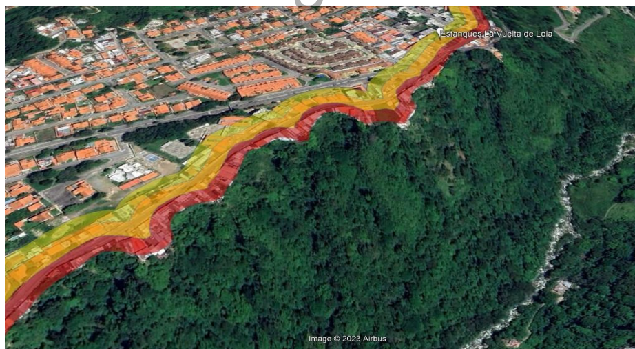
Figura 13 Rangos de riesgo de acuerdo a la cercanía al talud de los estanques de almacenamiento de la Vuelta de Lola. Color Rojo distancia al talud entre 0 y 20 metros. Color Naranja distancia al talud entre 20 y 40 metros. Color amarillo: distancia al talud entre 40 y 60 metros. Fuente: elaboración propia a partir la imagen de google earth, 2023.
