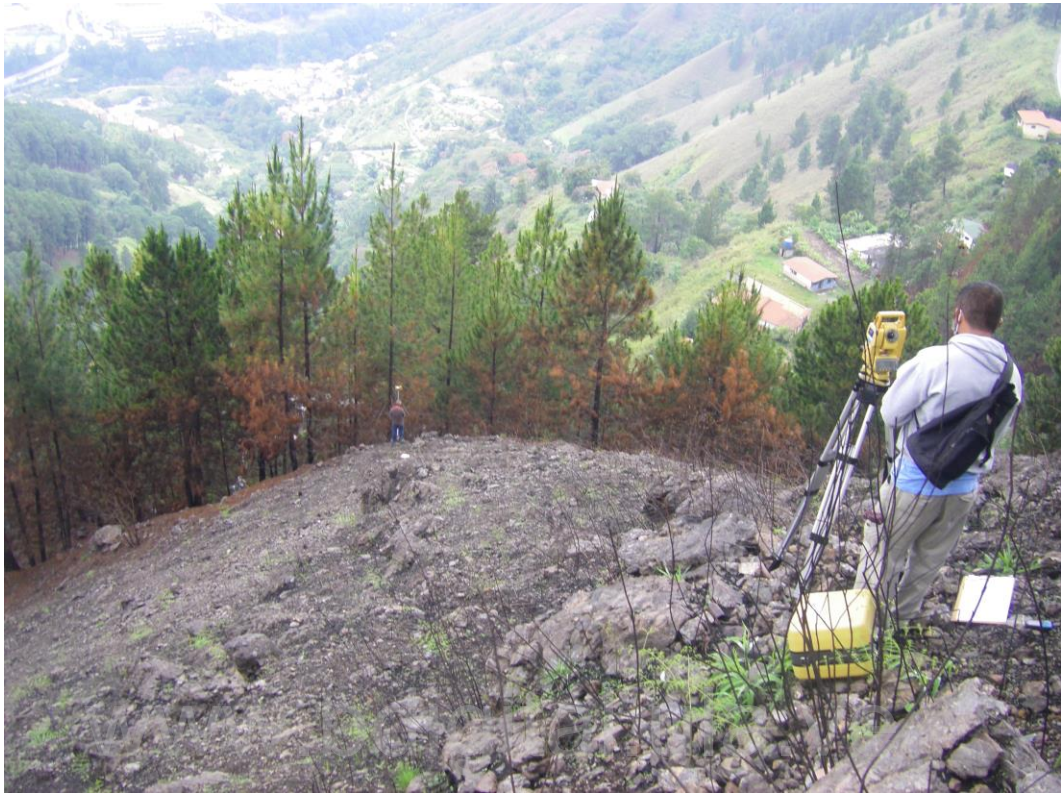
Fig. 1. Levantamiento topográfico de la ladera principal con el fin de estimar el área de la obra civil, y posible trayectoria de orientación de los caídos en función de la orientación de las pendientes. Ladera parte apical vista hacia la instalación industrial (Fotografía tomada en marzo de 2022).
