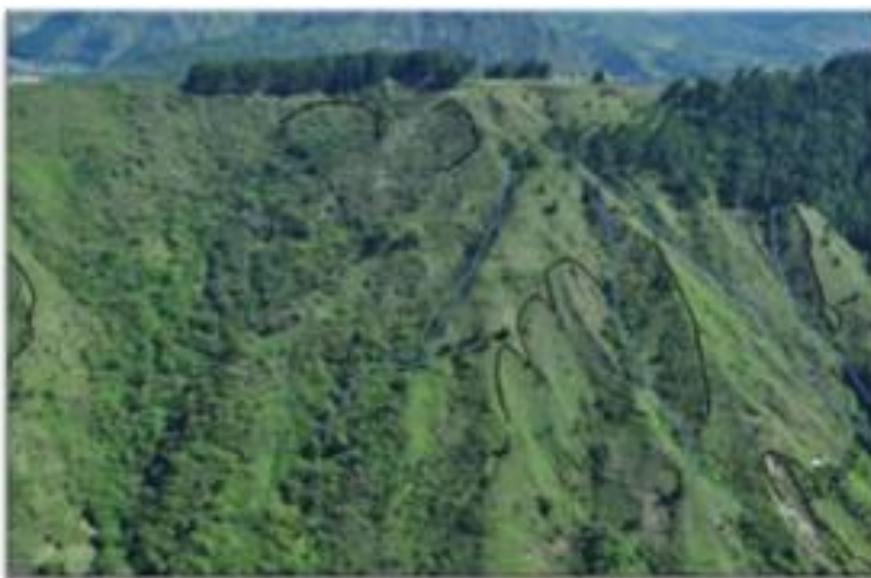
Figura 109. Fotografías otorgadas por INGEOMIN, se interpretan los movimientos de masa tipo deslizamientos, y cárcavas. Fuente: Vera, M. (2023).
