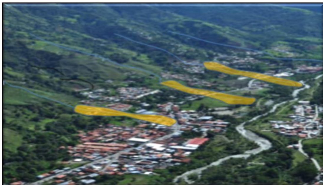
Figura 110. Se utilizaron fotografías donadas por INPRADEM. La imagen muestra la interpretación de los flujos y la fragilidad de edificaciones, obras civiles y vías de comunicación que se ubican en la misma dirección de flujo. Fuente: Vera, M. (2023).
