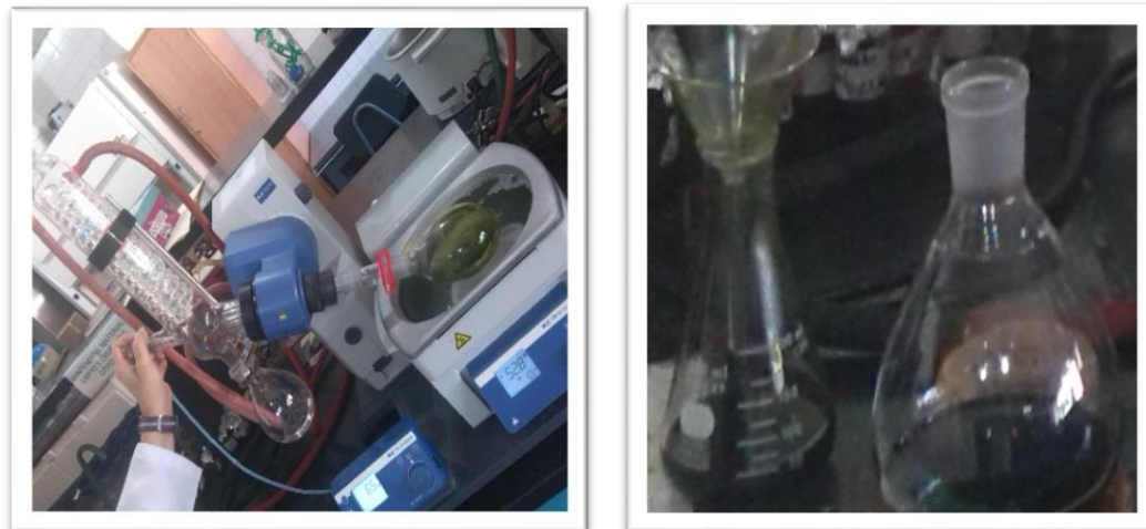
Figura 14. Remoción o evaporación del solvente
