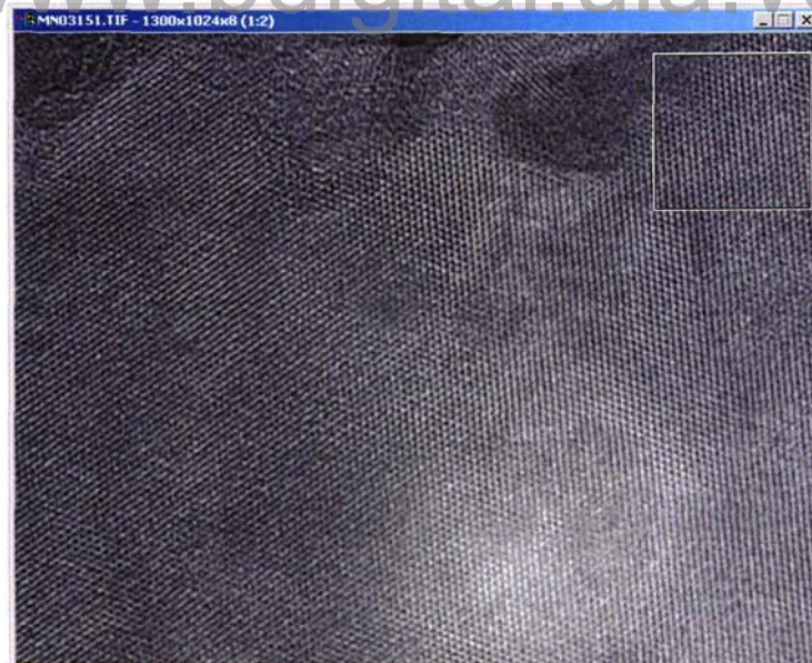
Fig. 9.19: Micrografía HRTEM para la aleación Zn_{0.7}Mn_{0.3}In_2S_4 , a lo largo c .
