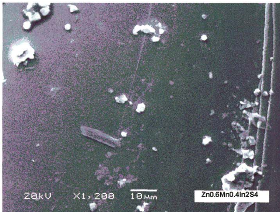
Fig. 9.3: Micrografía a 20 kV y 1.200X en la cual se aprecia la presencia de dos láminas de la aleación Zn_{0.6}Mn_{0.4}In_2S_4 .
