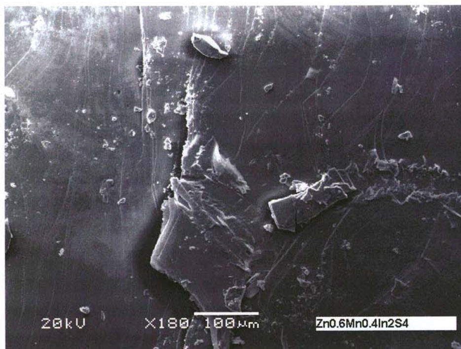
Fig. 9.1: Micrografía a 20 kV y 180X que muestra el aspecto morfológico laminar de la muestra Zn 0.6 Mn 0.4 In 2 S 4 .
