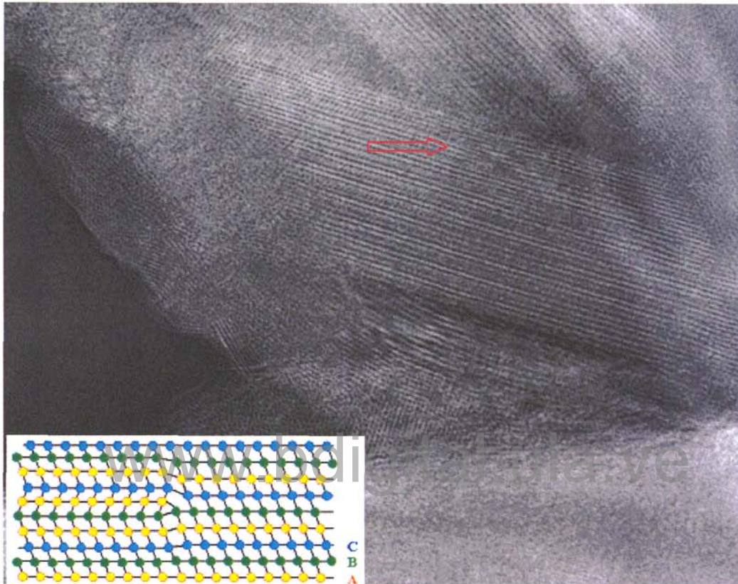
Fig. 9.35: Micrografía de HRTEM para la aleación Zn_{0.7}Mn_{0.3}In_2S_4 , la presencia de dislocaciones señaladas con una flecha, de acuerdo al tipo señalado en el recuadro de la izquierda, y que posiblemente corresponda a fallas de apilamiento abca.
