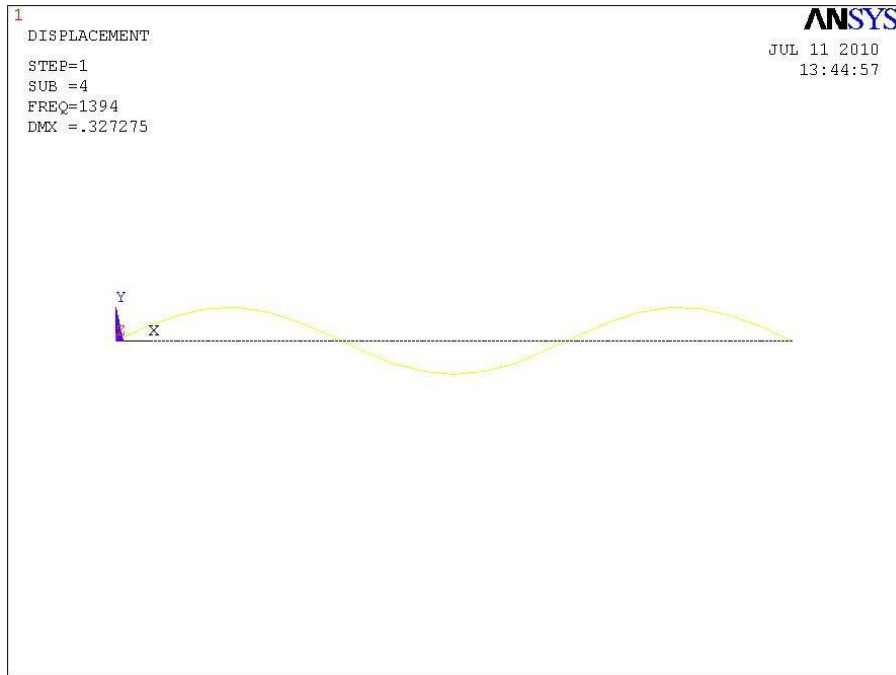
Figura 3-29. Cuarto modo de vibración ( D_N = 3 pulgadas).
