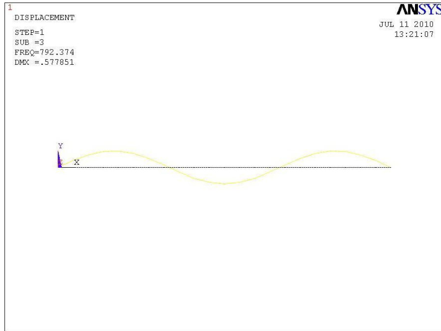
Figura 3-25. Tercer modo de vibración ( D_N = 1,5 pulgadas).
