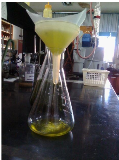
Figura 27. Filtración luego de la maceración
