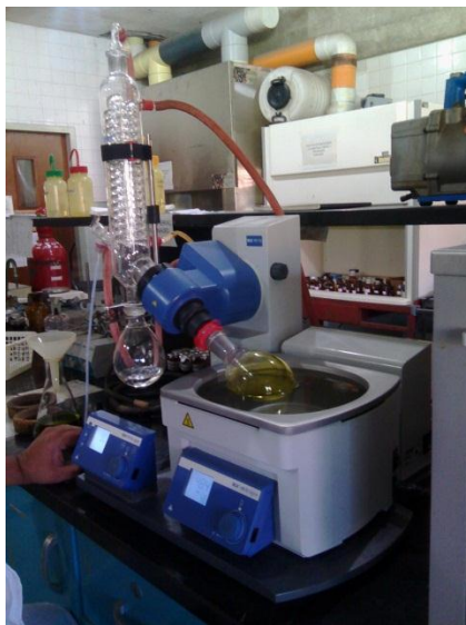
Figura 28. Concentración de los extractos en el rotavapor
