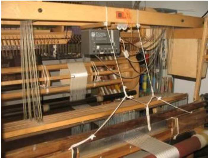
Figura 5. Telar dobby industrial electro-mecánico (celenoide)
