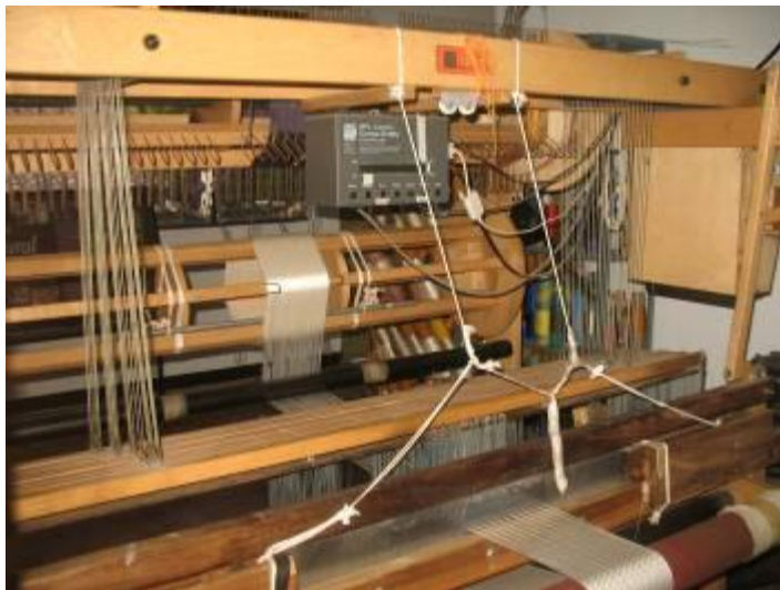
Figura 6. Telar dobby industrial electro-neumática tipo Jacquard.
