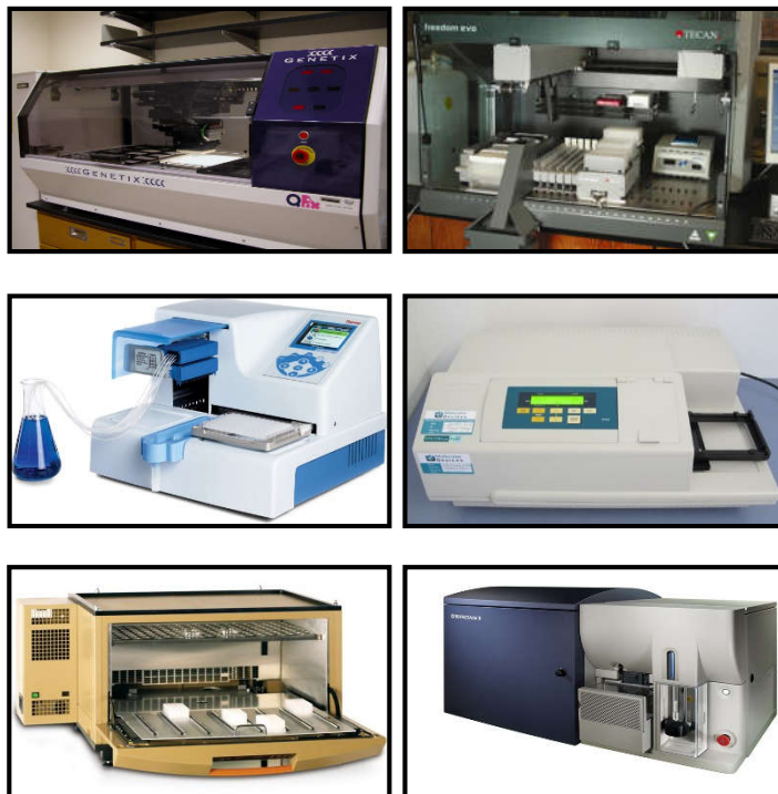
Fig. 4: Ejemplos de herramientas de cribado de alto rendimiento utilizadas en experimentos de evolución dirigida. (A) Robot picador de colonias. (B) Robot manipulador de líquidos. (C) Robot dispensador de líquidos. (D) Lector de microplacas. (E) Incubador de placas. (F) Citómetro de flujo.
