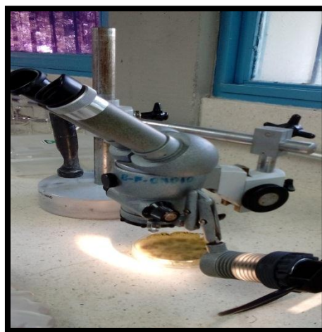
Figura 31. Lupa estereoscópica del Laboratorio de Farmacognosia, Facultad de Farmacia y Bioanálisis, ULA.
