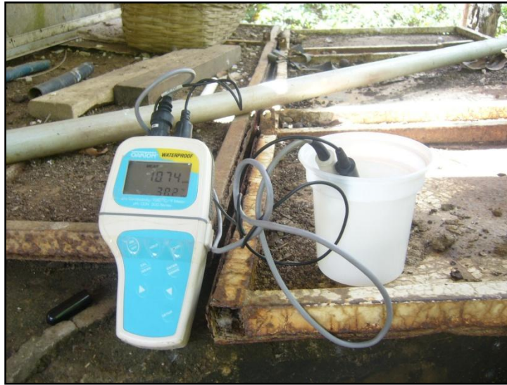
Figura 4.3.- Medición de conductividad eléctrica y salinidad con el multiparámetro. Fuente propia.
