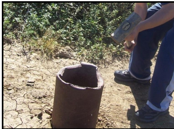
Figura 5.17. Modo de instalación del infiltrómetro.
