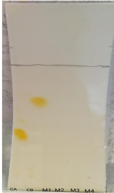
Figura 15. La presencia de organofosforados en el extracto se puede observar el crecimiento o recorrido de la placa de cromatografía con Paration y Pyrinex, y la ausencia del recorrido en los pozos de las muestras con el extracto.
