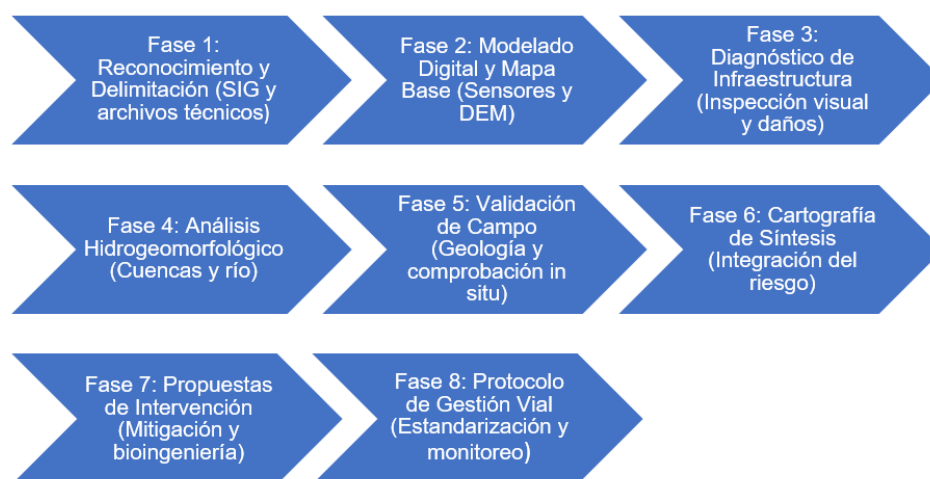
Figura 11. Diagrama de flujo del protocolo metodológico para la gestión y mantenimiento de la infraestructura vial
