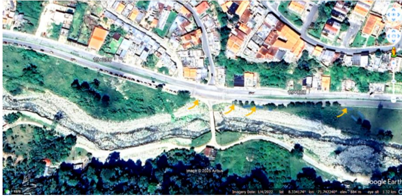
Figura 94. Acercamiento del río y riesgo de erosión lateral
