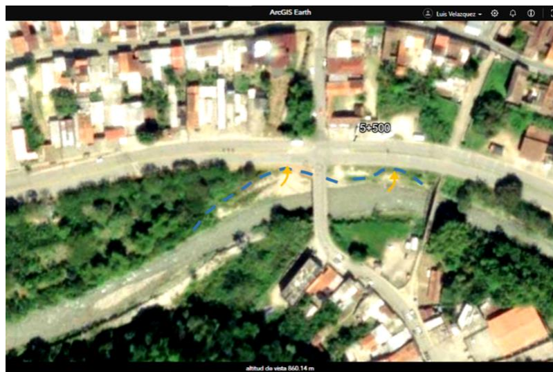
Figura 77. Paleocauces y riesgo de erosión lateral
