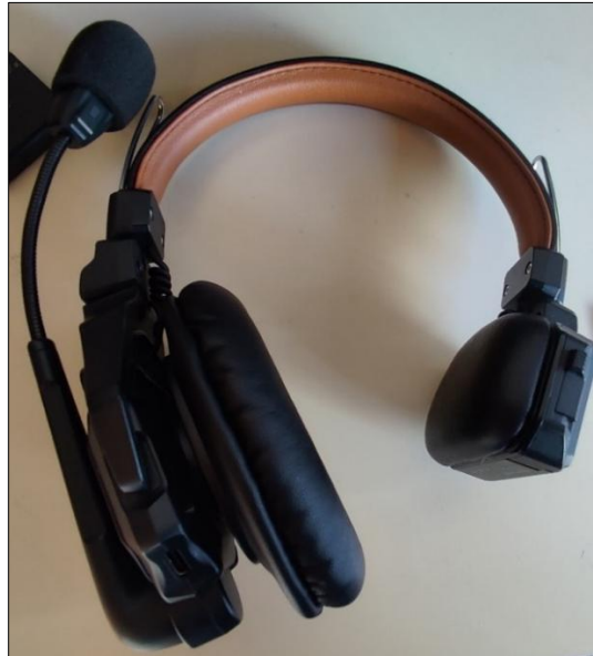
Figura 14 Sistema inalámbrico de intercom Fuente: fotografía propia del autor
