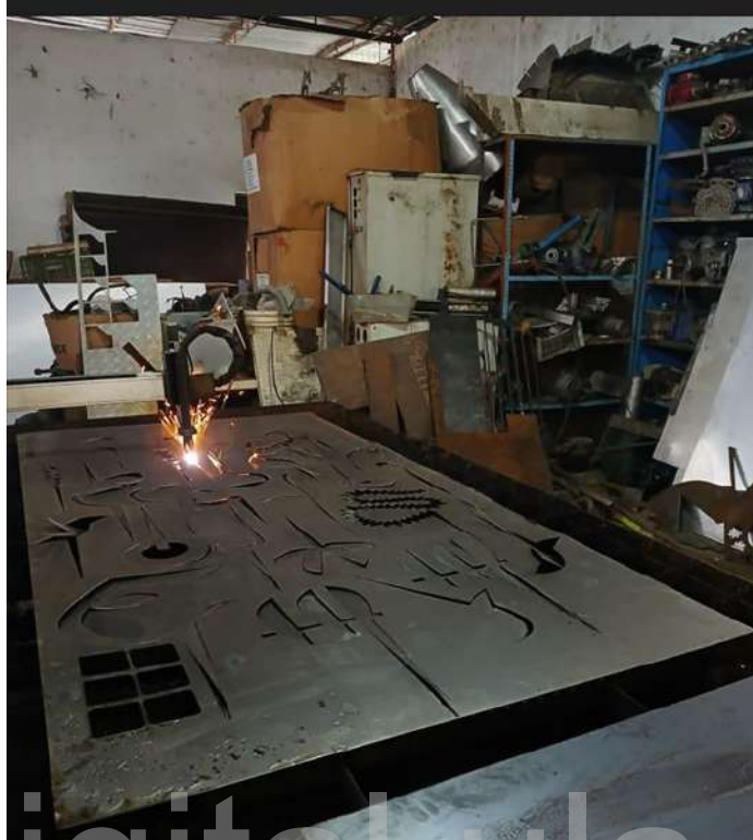
Maquina CNC realizando el corte
