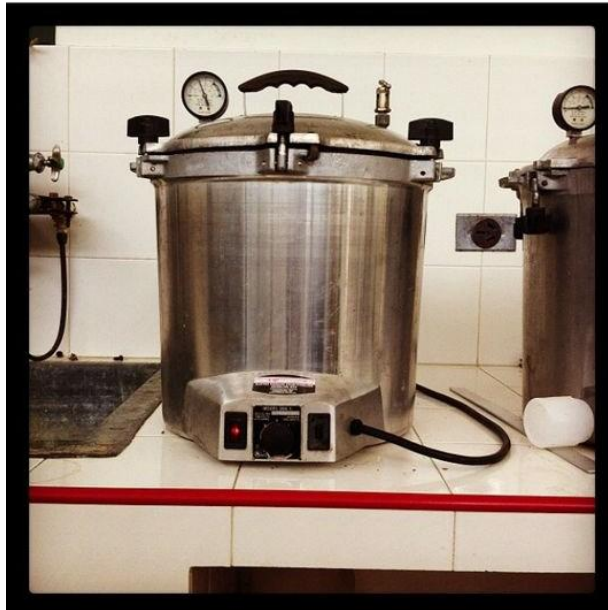
Figura 3.- Autoclave para esterilización de material y medios de cultivo (Laboratorio BIOMI)
