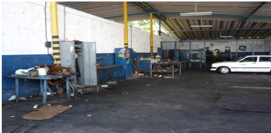
Fig. No. 5.1 Cubículos Taller Mecánico sin el rayado amarillo en el suelo reglamentario
