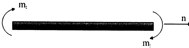
Figura 4.5 Esfuerzos generalizados en un miembro de pórtico plano [33].
