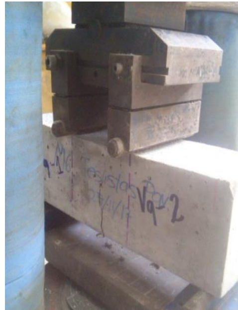
Figura 2. Colocación adecuada de la biqueta.
