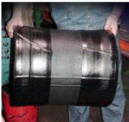
(a) Carcasa elaborada en la primera etapa de ensamblado, constituida por el forro interno, la tela de cuerpo, el forro del talón, los talones y capas laterales
